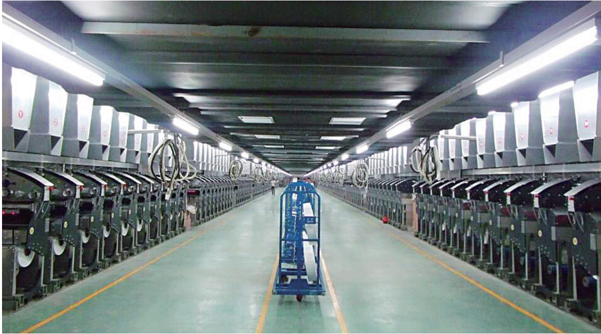
东南新材料德国Barmag POY 制造设备生产线
