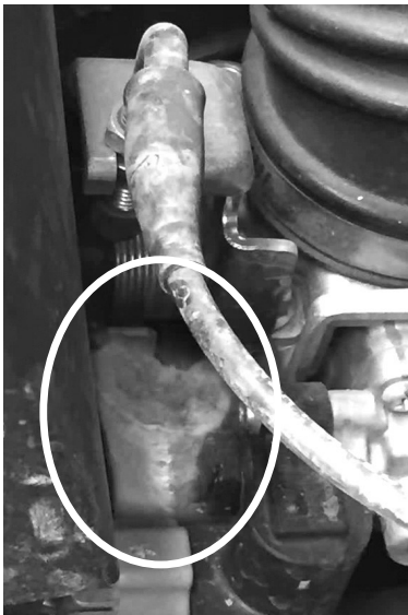
一根骨头卡在油门拉线和节气门的位置 张女士供图
