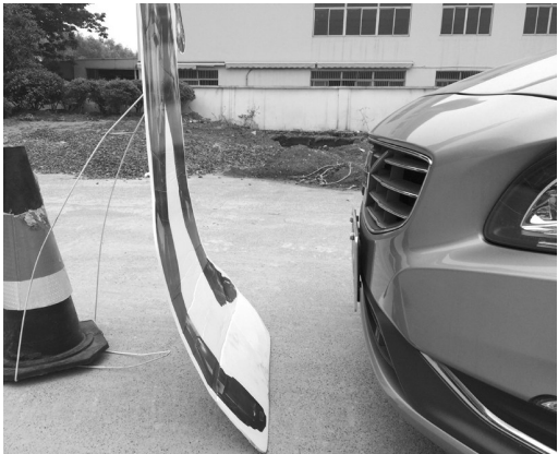
第二次,S60L在距离“钢铁侠”约0.5m处刹停。
