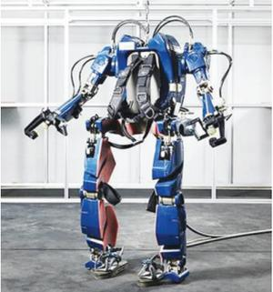
韩国现代汽车集团近日首次公开正在开发中的韩版“钢铁侠”实物。尽管韩版“钢铁侠”的构造不似电影里那样遮蔽全身,但只要系上安全带后就可以很容易地使用,成为现实中的可穿戴式机器人。现代汽车集团介绍,这款机器人功能实用,工人可以穿上它搬运重物,保护腰、膝盖等部位;士兵在穿上机器人后,可在负重50千克的情况下,以每分钟100米以上的速度行走。另外,机器人还可以帮助下半身瘫痪的残疾人及行动不便的老人移动。
