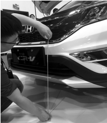
CR-V 发动机进气口离地距离73cm
