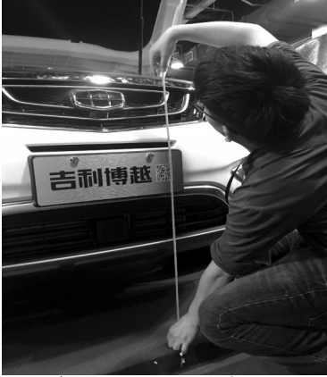
博越的发动机进气口高度为91cm
