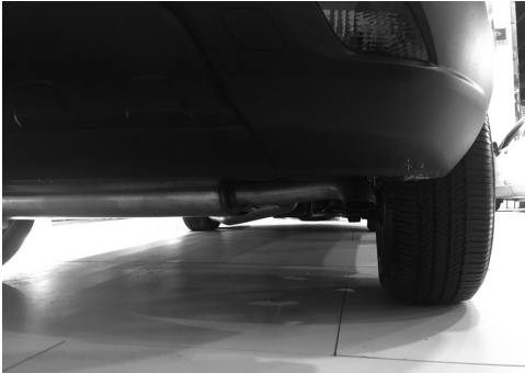
昂科拉车尾排气管向下,不易进水。
