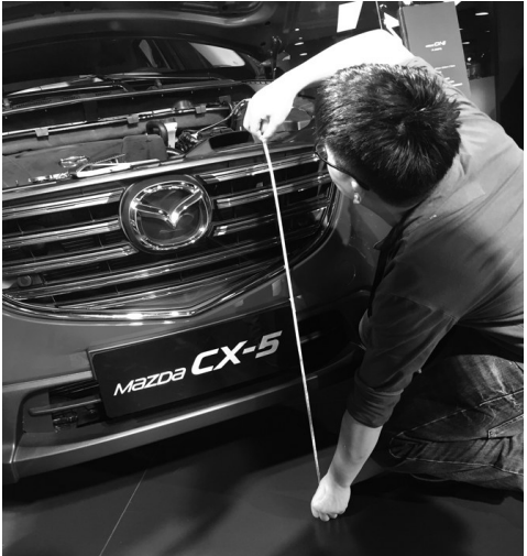
CX-5的发动机进气口高度实测有82cm
