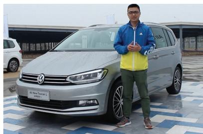
3月18日上市的全新途安L,提供280TSI、330TSI两款动力共7款车型,分5座和7座版。新车诞生自全新MQB平台,长宽高分别为4527mm/1829mm/1659mm,轴距2791mm;与上一代相比,车身长度与轴距分别增加132mm和113mm。
