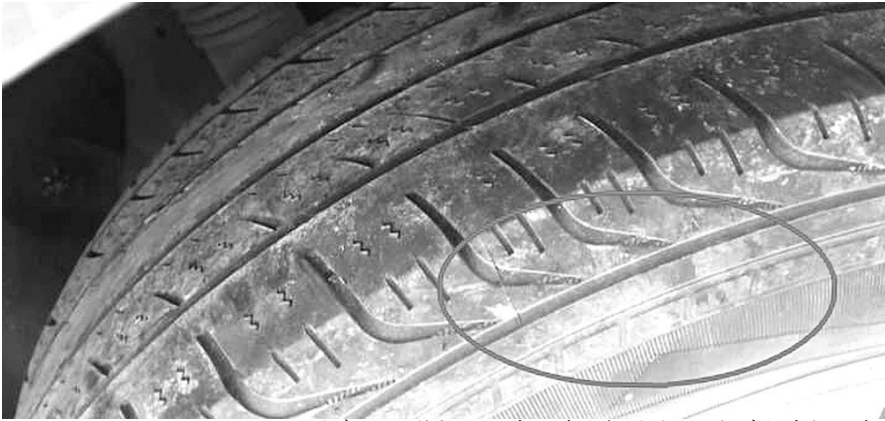
众泰 T600 维权 QQ 群里,车主提供的右后轮外侧磨损照片。
