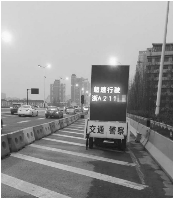
高架上滚动播报超速和实线变道车牌号的拖挂式电子显示屏（杭州交警高架大队供图）
